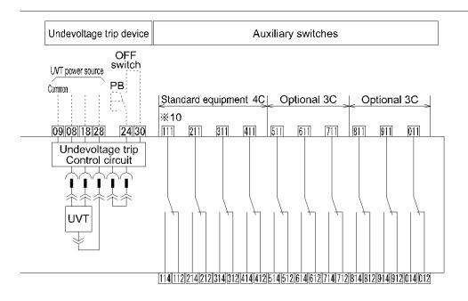
Fig. 12-2 Breaker circuits 2
