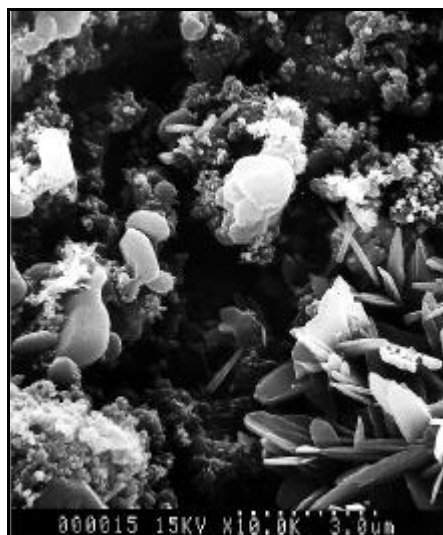
Figure II-1. Vue à fort grossissement (x10000) d'un filtre de prélèvement d'aérosols en milieu urbain.
