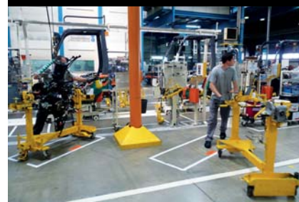
OPÉRATEURS SUR LA CHAÎNE DE MONTAGE DES CHARIOTS TONERO
