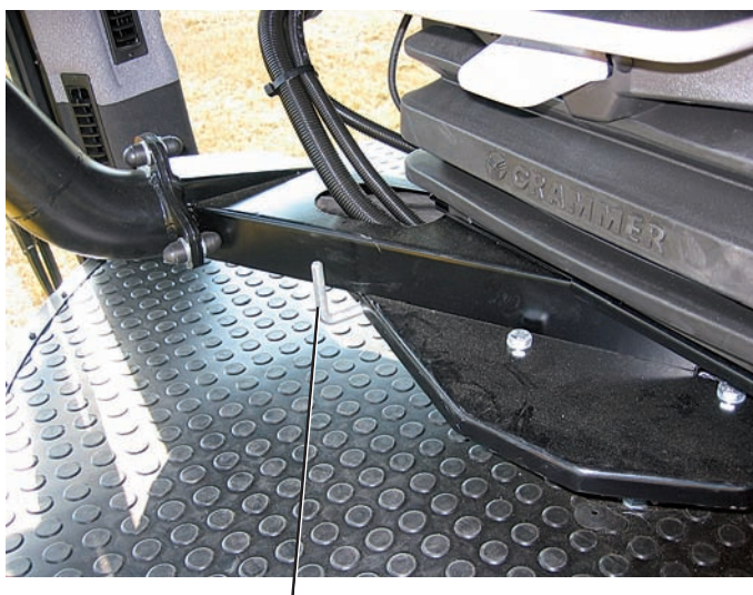
Blocage mécanique du siège pour conduite sur route
