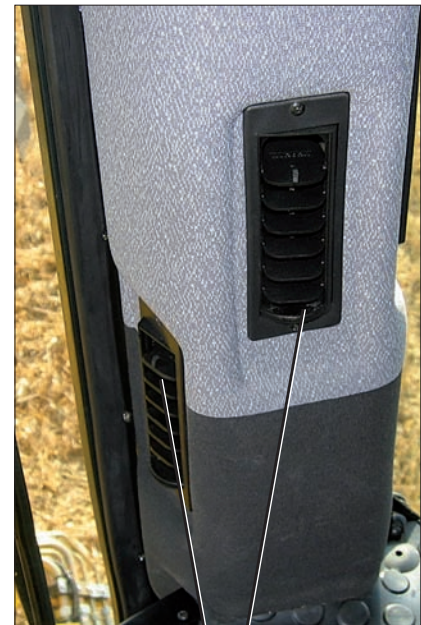
exemple: buses d'air dans la colonne droite A de la cabine conducteur
