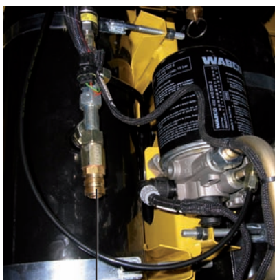
Accouplement à air comprimé au réservoir à air comprimé arrière (uniquement sur version sans dispositif de pulvérisation d'eau)
