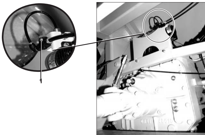
Robinet d'arrêt ouvert. Pour le fermer tourner de 90°.
