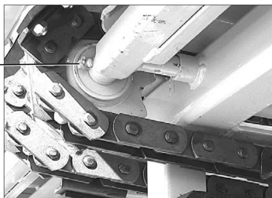
graisseur aux roues de renvoi des fonds mouvants 1 graisseur par roue de renvoi
