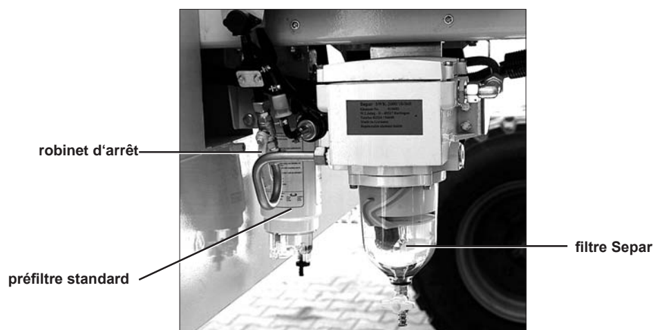
Filtre Separ: utilisé uniquement dans les machines pour les états de la CEI
