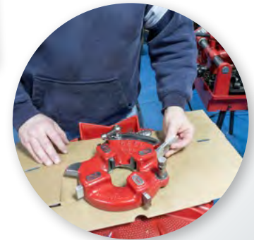
将通用模具安装到 R811 模头
