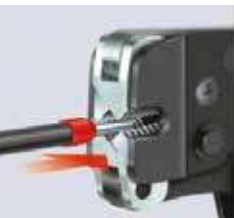
Εμπρόσθια πρόσβαση μυτών ακροκωτιώνων π.χ. απ' ευθείας σε πίνακες
