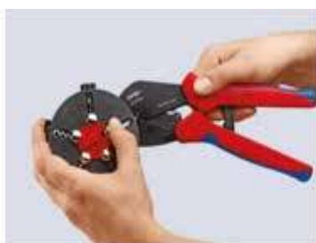
Αλλαγή εξαρτήματος ρυτίδωσης: Απασφαλίστε τη θέση του τροφοδότη, αφαιρέστε το εξάρτημα ρυτίδωσης στην τσιμπίδα
