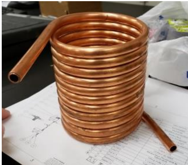
Figure 6 : Bobine de cuivre pour le refroidissement du mélangeur
