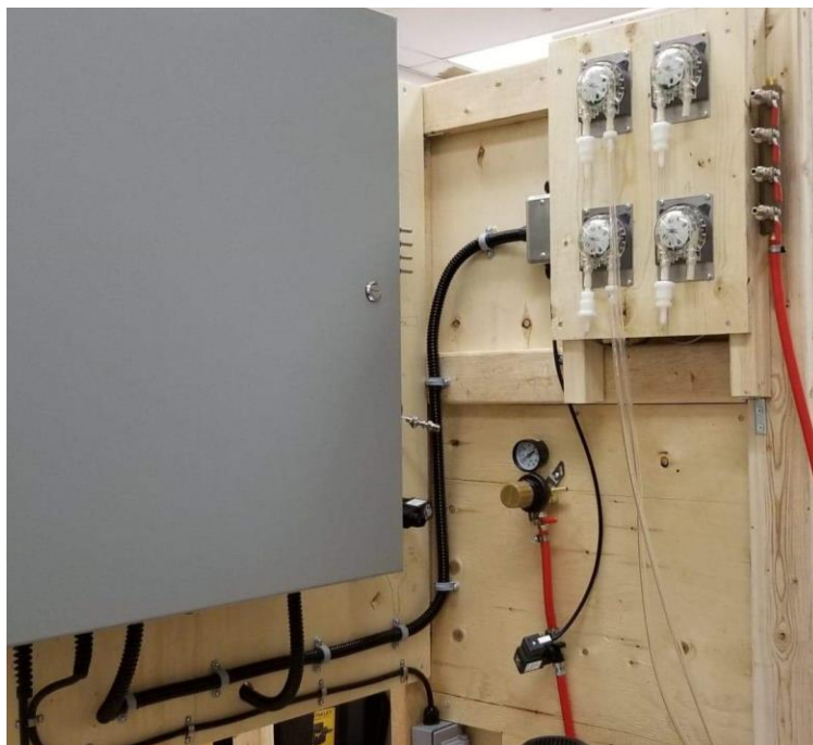
Figure 22: Boîte de jonction reliée au boîtier principal
