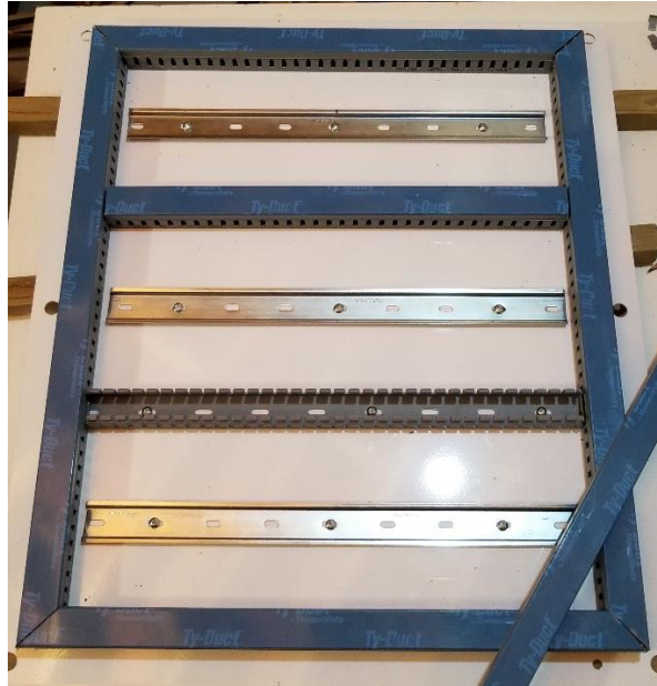
Figure 12: Installation des rails et des passages de fils
