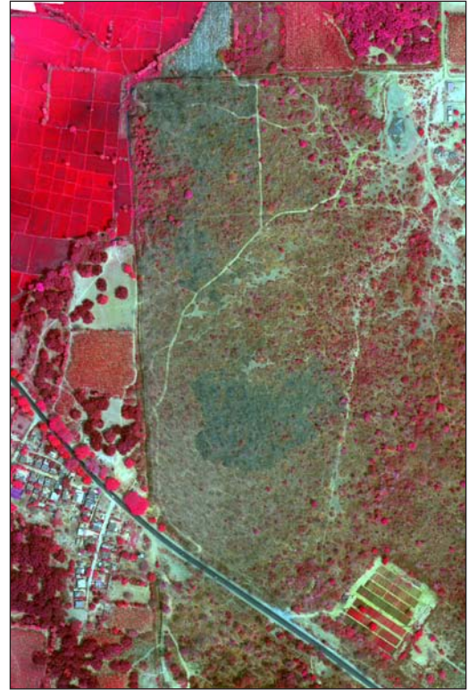
चित्र 7.3: ऑर्थोइमेज, एफसीसी, (जीएसडी: 8 से.मी.)-पलावंचा, तेलंगाना का हिस्सा Fig. 7.3: Orthoimage, FCC, (GSD:8cm) - part of Palawanacha, Telangana
