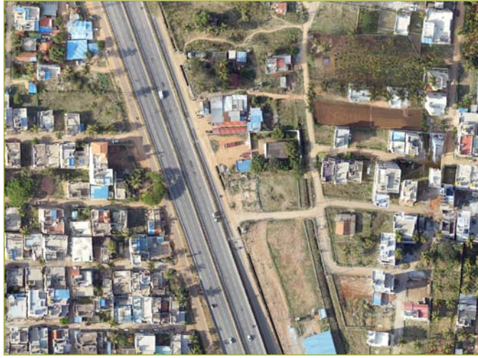
चित्र 7.1: डिजिटल कैमरा ऑर्थोइमेज (जीएसडी: 4 सेमी) – तुमकुरु, कर्नाटक का हिस्सा Fig. 7.1: Digital Camera Orthoimage (GSD:4 cm) – part of Tumkuru, Karnataka
