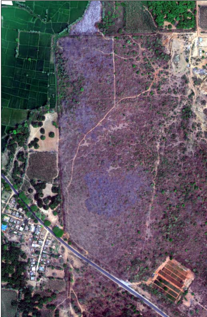
चित्र 7.2: डिजिटल कैमरा ऑर्थोइमेज (जीएसडी: 8 सेमी)-पलावंचा, तेलंगाना का हिस्सा Fig. 7.2: Orthoimage, NCC, GSD: 8cm - part of Palawanacha, Telangana
