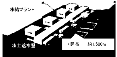
1~4号機建屋周りに凍土壁を設置し、建屋への地下水流入を抑制
