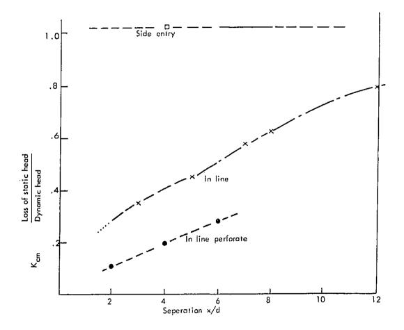
FIG. 8. BACK PRESSURE OF EXPANSION CHAMBERS.
