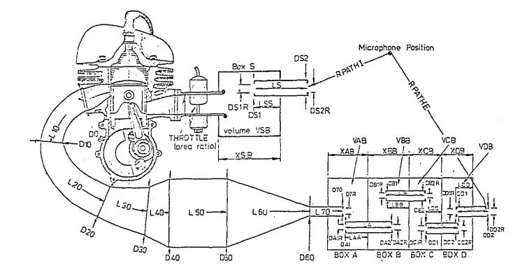
EXHAUST AND INTAKE SILENCING BOX PARAMETERS REQUIRED FOR PROGRAM GPB 2.
