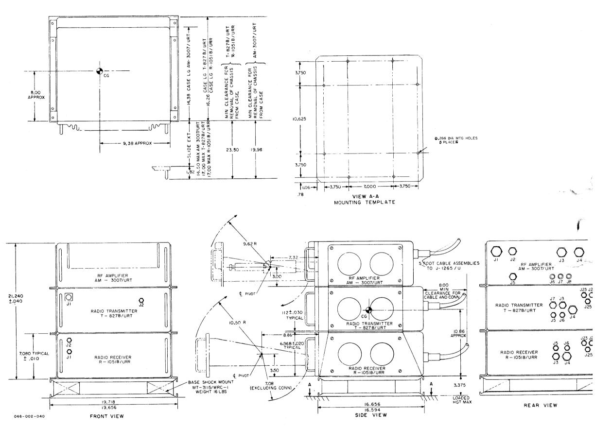
Figure 7-1. Radio Set AN/WRC-System Instal
