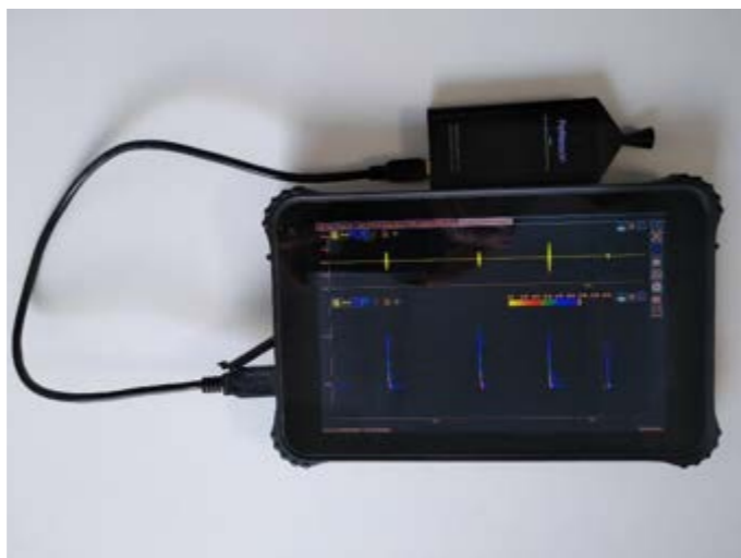
Photo 2 : Détecteur ultrasons Pettersson M500 et logiciel BatSound Touch
