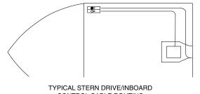
CONTROL CABLE ROUTING (MEASURE CABLE PATH + ROUND UP TO NEXT EVEN FOOT)
