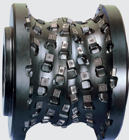
Profilvorfräser für Drehkolben (Rootsgebläse) 2teilig, Ø 312 x 260 x Ø 120 mm, 92 Wendepplatten Profile roughing cutter for rotary pistons (Roots blower) 2-section, 312 mm dia. x 260 x 120 dia., 92 indexable carbide inserts
