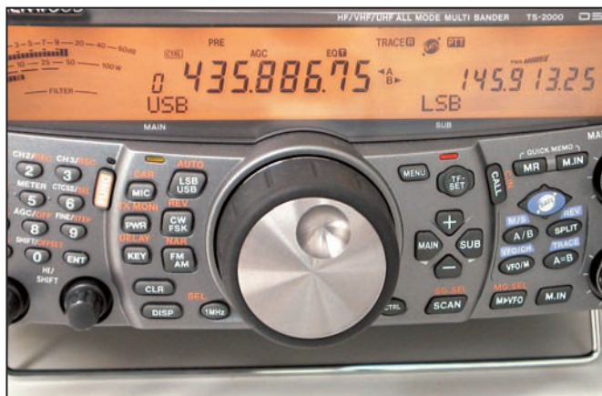
L'afficheur LCD du TS-2000 en mode SAT.
