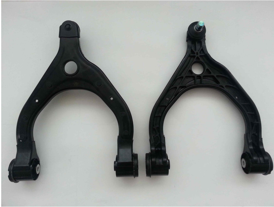
<금속-플라스틱(복합재) Hybrid Control Arm; Tesla 양산사양>
