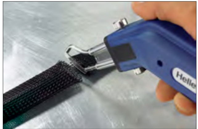
HSG0 sıcak kesme aleti örgülü makaronun saçaklanmasını önler.
