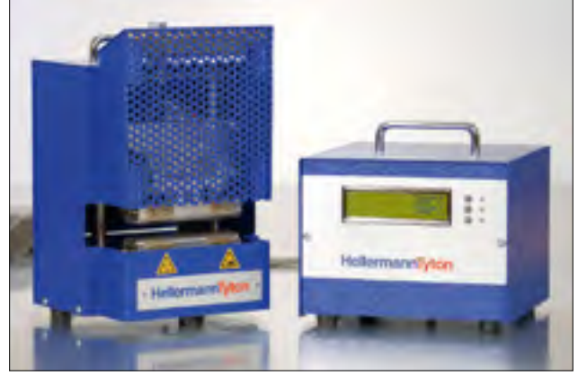
ShrinkPad 110 - kontrol ünitesi, pres ünitesi, güç kablosu ve pedal.
