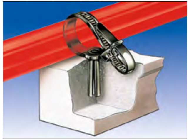
Uygulamadaki bir duvar fişi bağı.
