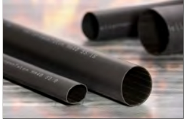
HA40 gemi inşaatı için kalın cidarlı, yapışkan astarlı ve alev geciktirici makaron.
