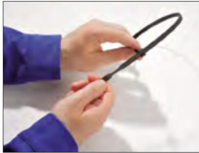
2. Kablo bağını demet sabitlenene kadar çekiniz 3. artan parçayı bir uygulama el aletiyle kesiniz.
