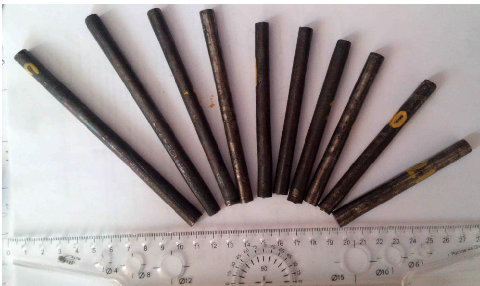
Рисунок 86 – Опытная партия образцов электродов в виде цилиндрических стержней
