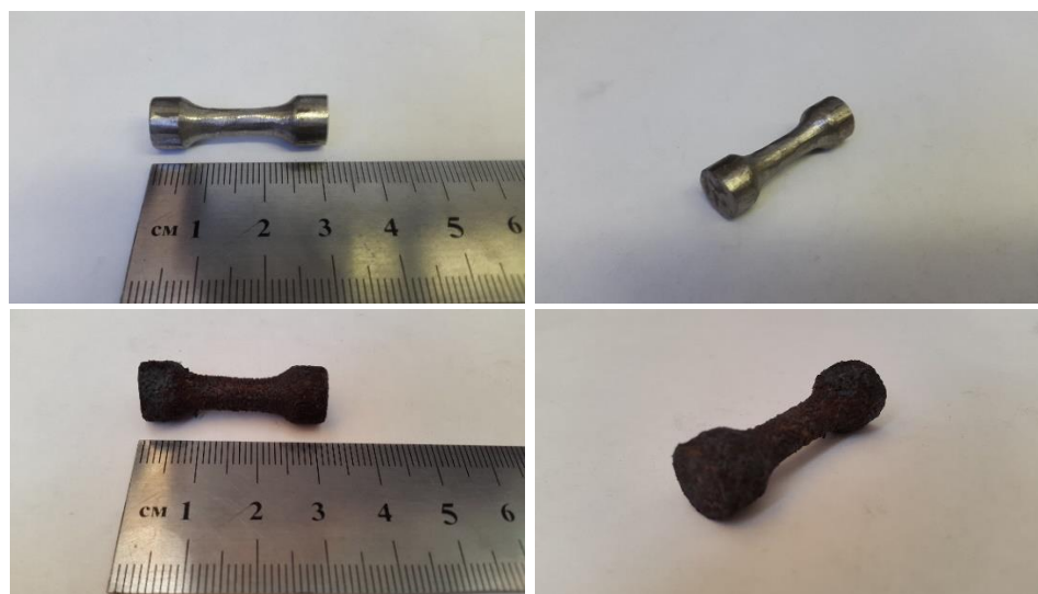
Рисунок 78 – Фото образца состава 50%TiB 2 +(80масс.%Fe-20масс.%Ti) до и после испытания на термоудар
