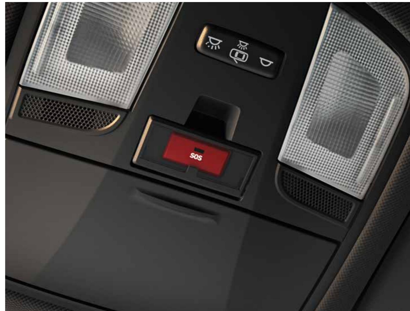
E-call. Em caso de acidente e se os airbags ativarem, este sistema automaticamente liga para o 112 para que o envio de ajuda seja o mais eficaz e rápido possível. Pode, também, pressionar no botão de SOS numa situação de emergência e terá apoio 24/7, 365 dias por ano.
