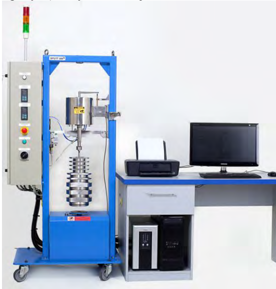
Obr. 1 Zkušební stroj pro SPCT zkoušky SPUTT 500 Fig. 1 Small punch creep testing machine SPUTT 500
