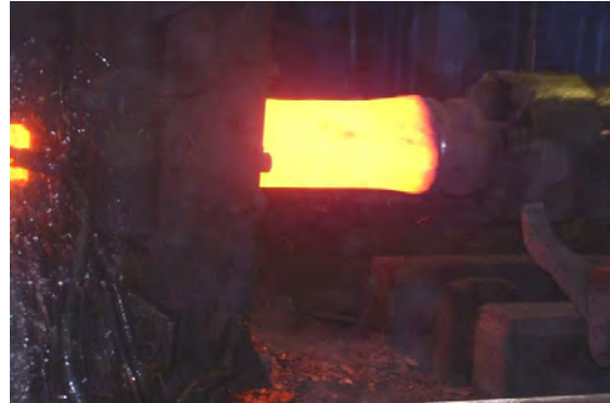
Obr. 9 Válcování na poutnické stolici Fig. 9 Rolling on the pilgrim mill
