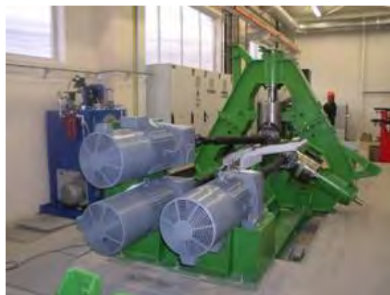
Obr. 3 Univerzální válcovací stolice pro výrobu bezešvých trub – pohled od pohonů Fig. 3 Universal rolling mill for the production of seamless pipes - view from the engines
