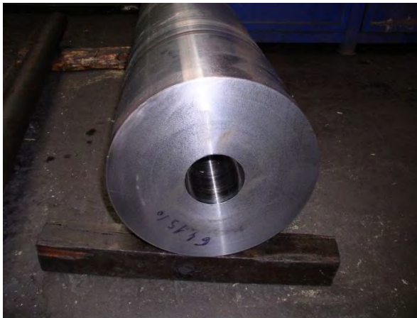
Obr. 7 Vyrtná díra \varnothing 90 mm v ose výkovku Fig. 7 Drilled hole \varnothing 90 mm in the axis of the forged piece
