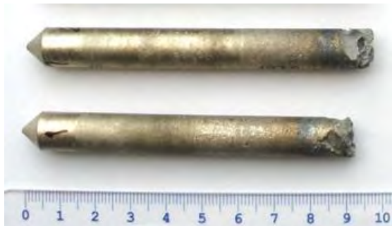
Fig. 1 Rods after directional solidification Obr. 1 Tyče po směrové krystalizaci
