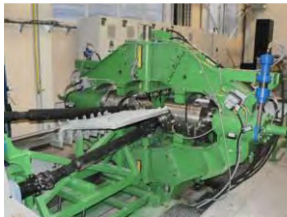
Obr. 5 Dvouválcová varianta válcovací stolice Fig. 5 Two rolls variant of rolling mill
