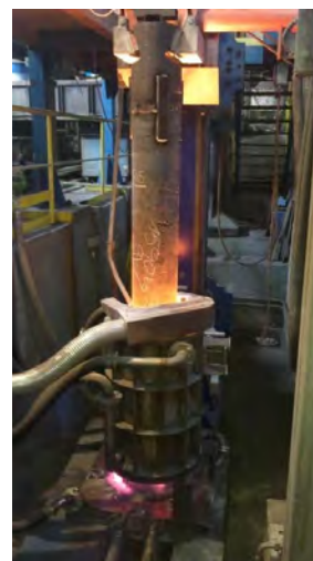
Obr. 4 Přetavba elektrody na zařízení ESR
