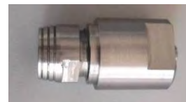
Obr. 3 Sestavená zkušební patrona Fig. 3 Assembled testing cartridge
