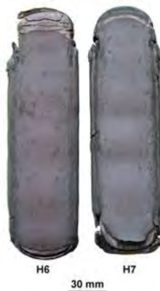
Obr. 2 Vývalky v kapslích po válcování (vzorek H6 – rychlost otáčení válců 40 min -1 ; vzorek H7 – 80 min -1 ) Fig. 2 Rolled products in capsules after rolling (specimen H6 – rotational speed of the rolls 40 rpm; specimen H7 – 80 rpm)
