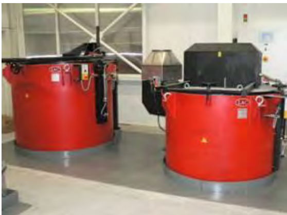
Obr. 9 Kalicí (vlevo) a popouštěcí pec (vpravo) Fig. 9 Quenching (left) and tempering furnace (right)
