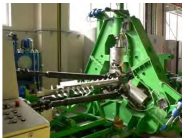
Obr. 4 Tříválcová varianta válcovací stolice Fig. 4 Three rolls variant of rolling mill
