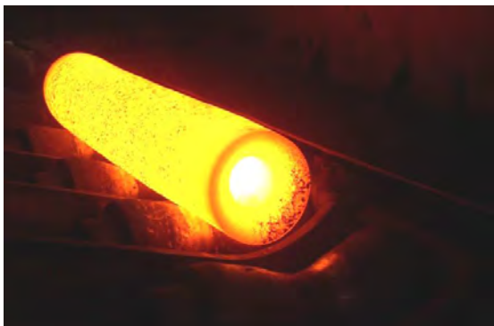
Obr. 8 Kruhový děrovaný předvalek \varnothing 130 mm po rozválcování na Mannesmannově válcovacím stroji Fig. 8 Circular pierced semi-product \varnothing 130 mm after rolling on the Mannesmann rolling machine
