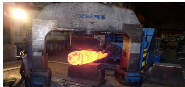
Obr. 6 Kování slítku ESR z \varnothing 415 mm na \varnothing 345 mm
