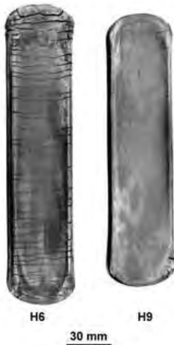
Obr. 3 Půdorysné plochy vybraných vývalků (vzorek H6 – rychlost otáčení válců 40 min -1 ; vzorek H9 – 150 min -1 )
