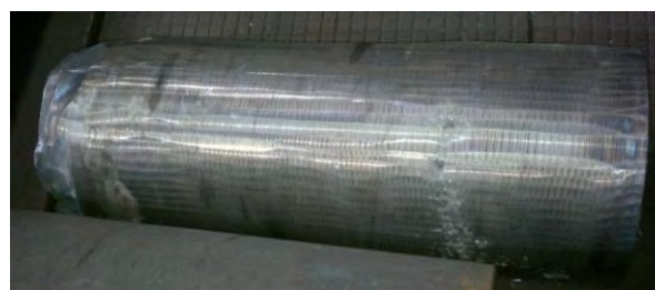
Obr. 5 Slítek po ESR jakosti 10Cr obroušen z \varnothing 430 mm na \varnothing 415 mm
