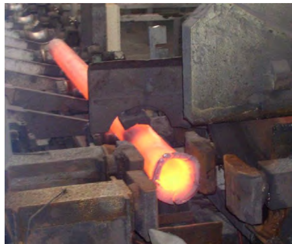
Obr. 10 Odřezávání konců trubek po válcování na poutnické stolici Fig. 10 Sawing of ends of tube after rolling on the pilgrim mill
