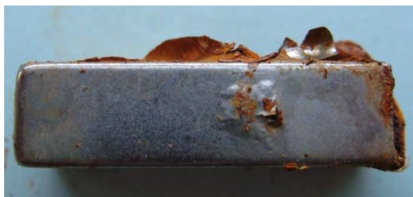
Obr. 3 Magnet ve tvaru hranolu s poškozeným povlakem Ni/Cu /Ni, pohled na boční stěnu, po expozici 240 hod.
