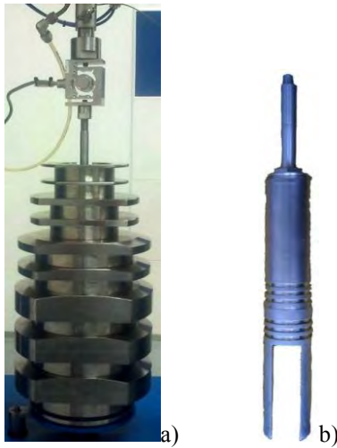
Obr. 5a) Sestava závaží a tenzometr měření zatížení Obr. 5b) Testovací vidlice Fig. 5a) Set of weights and load measurement gauge Fig. 5b) Testing fork
