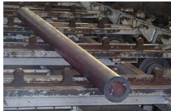
Obr. 11 Konečný produkt – trubka po válcování a odřezání konců Fig. 11 Final product – tube after rolling and cutting off of its ends
