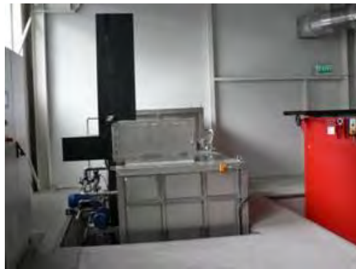
Obr. 10 Kalicí centrum pro kalení přířezů trubek do vodní lázně, nebo vodní sprchou Fig. 10 Quenching center for hardening of tube rings, in a water bath, or water mist
