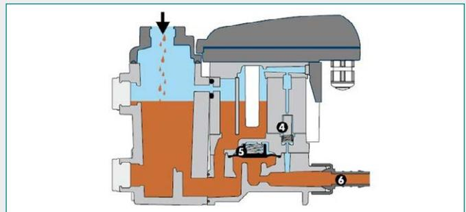
La membrane (5) ouvre la conduite d'évacuation (6) pour évacuer l'eau de condensation lorsque la soupape-pilote (4) est activée. Si le purgeur de condensat est vidangé, la conduite d'évacuation se referme immédiatement pour pouvoir éviter une perte de pression inutile.
