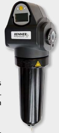
Les filtres à air comprimé RENNER servent à la séparation des aérosols d'huile et d'eau ainsi qu'à l'élimination des contaminants solides présents dans l'air comprimé. Même les particules de poussière sont assurément retenues à la surface et au fond de la matière filtrante. En utilisant différents mécanismes, comme la séparation par interception directe, l'impact d'inertie et le mouvement brownien, on parvient à une performance de séparation d'environ cent pour cent.
