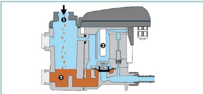
Le condensat pénètre dans le purgeur de condensat en passant par la conduite d'alimentation (1) avant de s'accumuler dans le carter (2). Un capteur à fonctionnement capacitif (3) enregistre en permanence le niveau de remplissage et envoie un signal à la commande électronique dès que le réservoir est plein.
