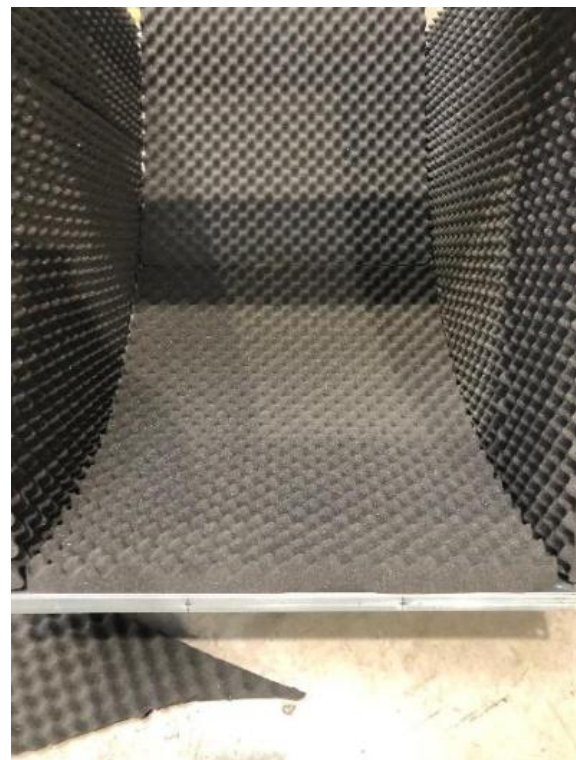
Dispositif de réduction de bruit pour les groupes électrogènes du site de POWER SOLUTIONS
