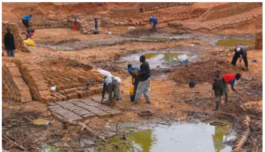
Fabrication de briques de banco au Mali.
