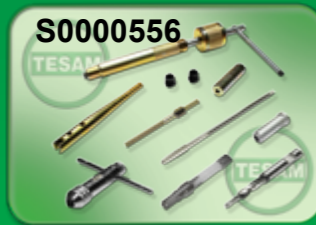
S0000556 M9 Zestaw do rozwiercania urwanej świecy żarowej
