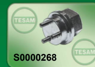
Denso Klucz do zaworka wtryskiwacza
