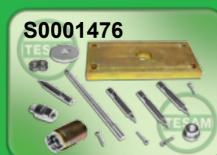
S0001476 Ściągacz wtryskiwaczy Ford Transit 2.2 TDCI Denso
