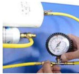
aprire lentamente il rubinetto fino al raggiungimento del valore della pressione necessario. Richiudere il rubinetto. Rimuovere la bombola d'azoto e scollegare successivamente le altre parti
