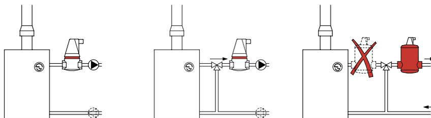
Impianti di riscaldamento: installare Flamcovent nella condotta di mandata, immediatamente a valle della caldaia o della valvola di miscelazione, preferibilmente a monte della pompa di circolazione.
