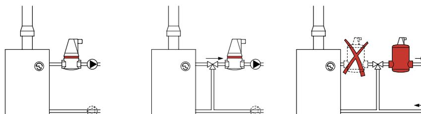
Impianti di riscaldamento: installare Flamcovent nella condotta di mandata, immediatamente a valle della caldaia o della valvola di miscelazione, preferibilmente a monte della pompa di circolazione (fig. 1, 2, 3).
