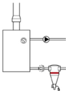
Installare Flamco Clean in un luogo asciutto, al riparo dal gelo e facilmente accessibile per le operazioni di manutenzione.
