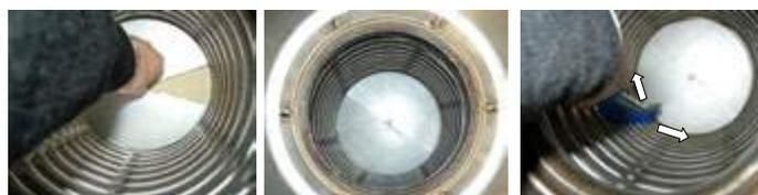
Istruzioni per inserimento disco nello scambiatore. Procedure più precise e dettagliate sono presenti all'interno del kit.
