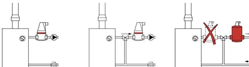
Impianti di riscaldamento: installare Provent nella condotta di mandata, immediatamente a valle della caldaia o della valvola di miscelazione, preferibilmente a monte della pompa di circolazione.
