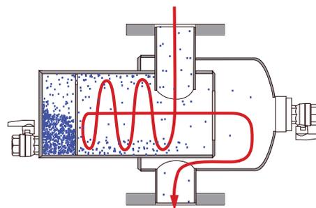
Il principio ciclonico funziona indipendentemente dall'orientamento. Pertanto il separatore può essere installato in orizzontale, in verticale o in qualsiasi altra posizione.
