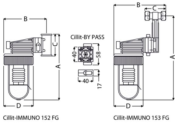
**Esempi di installazione Cillit Immuno 152 - 153 By-Pass FG - 2 sull'acqua di alimento a caldaie murali**
