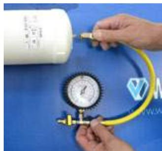
collegare il tubo con manometro di controllo al vaso di espansione e controllare sul manometro la relativa pressione
