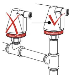
Per assicurare la tenuta applicare nastro teflonato sul raccordo di Flexvent e (se presente) della valvola di intercettazione.
