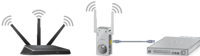
**Figure 4.** Connectez un périphérique au port Ethernet du répéteur
