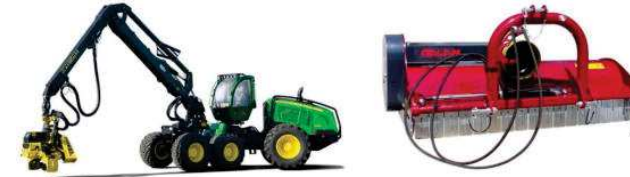
Illustration d'une abatteuse à pneus basses pressions et d'un rotobroyeur
