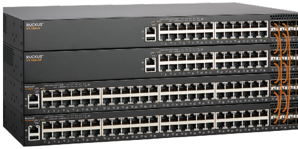
Figure 1 : Jusqu'à 12 switches Ruckus ICX 7250 peuvent être empilés ensemble, en utilisant jusqu'à quatre ports SFP+ 10 Gbit/s en full duplex pour une connexion intra-pile entièrement redondante avec 480 Gbit/s de bande passante d'empilage agrégée.
