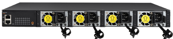
Figure 2 : Ruckus ICX-EPS 4000 pour le Ruckus ICX 7250, illustré avec quatre alimentations AC.
