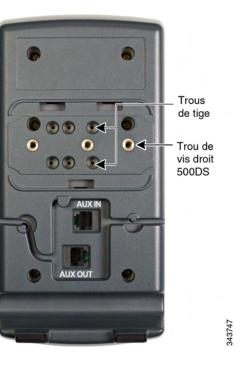
ÉTAPE7 Fixez le bras de fixation à la console Cisco SPA500DS à l'aide de la vis du bras de fixation.
