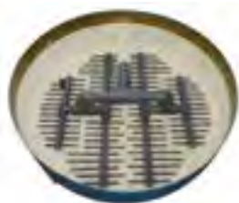
Réseau crépiné inférieur
