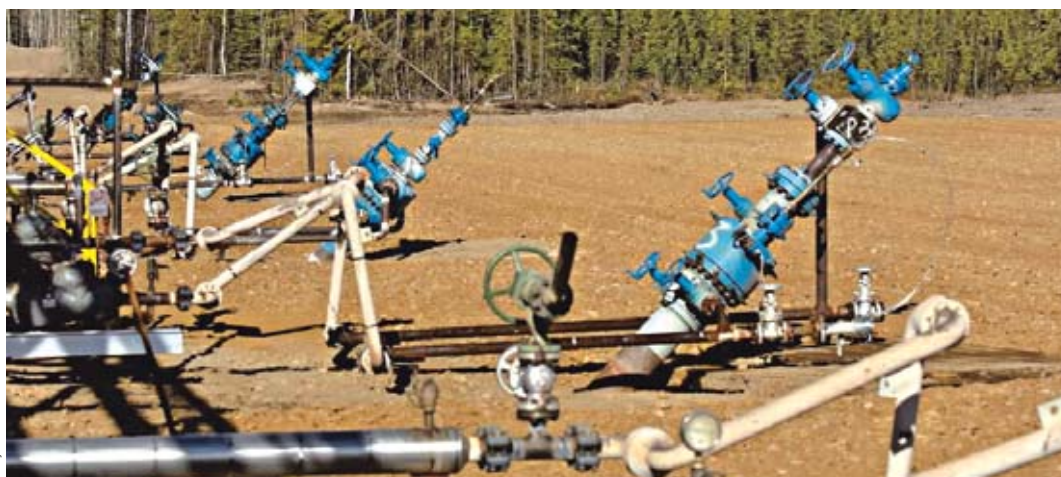
Têtes de puits sur le site de Joslyn en Athabasca (province de l'Alberta, au Canada) servant à l'extraction par le groupe Total de sables bitumineux (qui contiennent de l'huile extra-lourde) par récupération thermique avec injection de vapeur (procédé SAGD).
