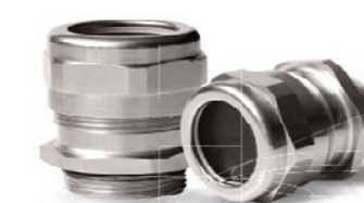
Heavy Duty kabelwartels Messing vernikkeld, IP66-IP68 Temperatuur bereik: -40°C tot +100°C Conform IEC 62444
