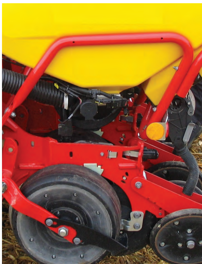
La distribution est entraînée par un moteur électrique (source : Chambre d'agriculture du Gers).
