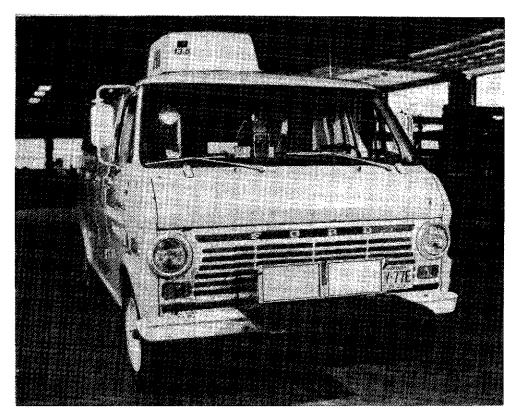
FIGURE 65. TEST VAN FOR RECORDING OF VIDEO AND RADAR INFORMATION.
