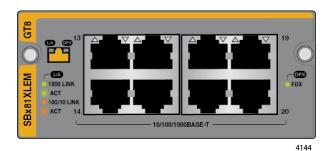
Figure 25. AT-SBx81XLEM/GT8Expansion Module
