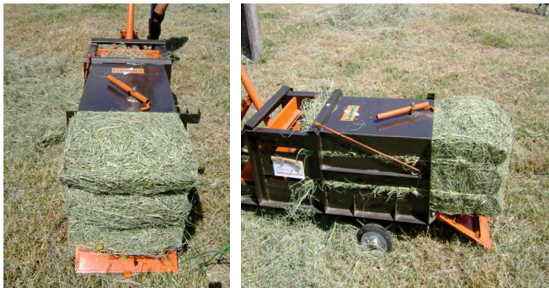
Figura 7 – Produção de fardos de feno de capim-tifton 85 feito com enfardadeira manual.
