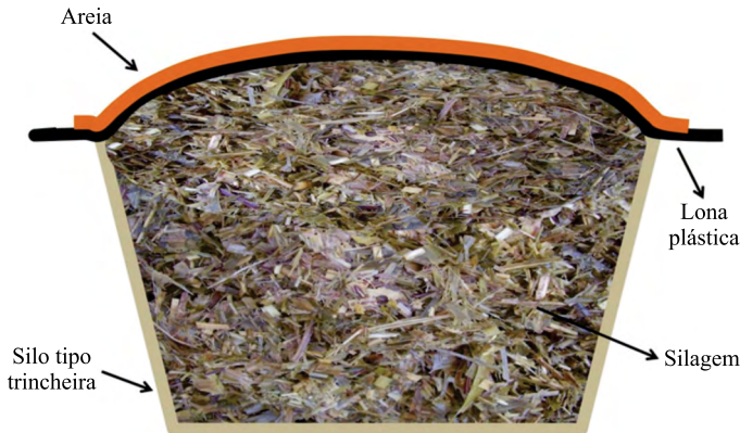
Figura 10 – Vedação correta do silo com vistas a não permitir aquecimento pela luz solar, danos na lona de vedação por animais ou pela chuva, etc.
