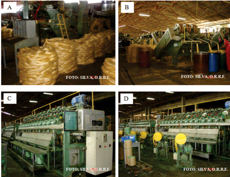
Figura 13 – Confeção de fios de sisal: (A) máquina good para a formação de mechas; (B) passadeira para a formação de mechas mais finas e regulares; (C) fiadeira para a confecção do fio e (D) bobinas com fios
