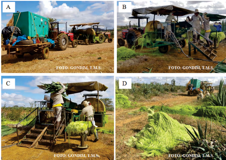
Figura 8 – Máquina de desfibramento automático de folhas de sisal pertencente à Fazenda Mandacaru de propriedade da Companhia de Sisal do Brasil (COSIBRA): (A) Conjunto móvel desfibrador das folhas de sisal com gerador, máquina e trator para deslocamento ao longo do carreador; (B e C) abastecimento das folhas de sisal na plataforma da embocadura de abastecimento na máquina; (D) fibra úmida e resíduo do desfibramento deixado em cada estação de funcionamento do conjunto móvel desfibrador. Santaluz, BA, 2018
