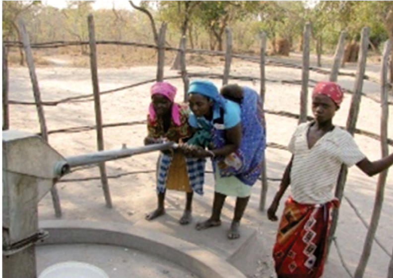
Foto tirada em Moçambique. Modelo da bomba Afridev, fabricado na Índia. Arquivo do Irpaa.
