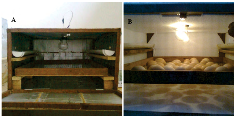
FIGURA 3 – A) Bandeja de incubação e nascimento dentro da incubadora; B) Bandeja com ovos durante incubação
