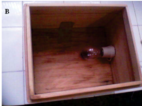
Figura 6 – Ovoscópio artesanal. A) Vista externa; B) Vista interna.
