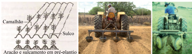
Figura 10 – Desenho esquemático do sistema de cultivo, composto de aração e sulcamento em pré-plantio (esquerda); Sulcamento pré-plantio com sulcadores (centro); Sulcamento pré-plantio com discos (direita)
