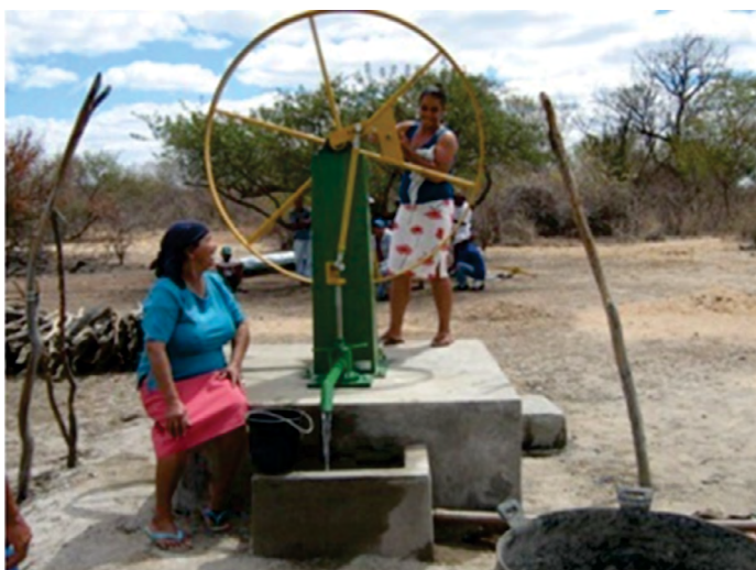
Figura 1 – Bomba Volanta, hoje Bomba d’água popular
