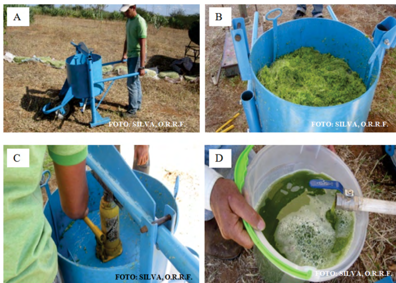
Figura 16 – Prensa extratora do suco de sisal: (A) Prensa hidráulica itinerante de acionamento manual; (B) prensa abastecida com resíduo do desfibramento; (C) acionamento da prensa para extração do suco de sisal e (D) suco de sisal
