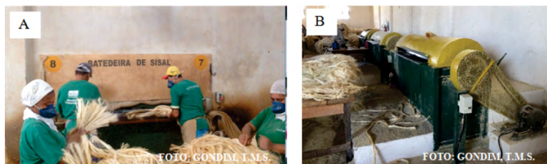
Figura 11 – Beneficiamento da fibra de sisal: (A) operação de batimento da fibra; e (B) detalhe de bateadeira da fibra de sisal
