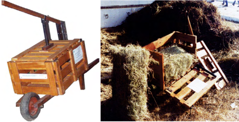
Figura 8 – Produção de fardos de feno feito com prensa manual
