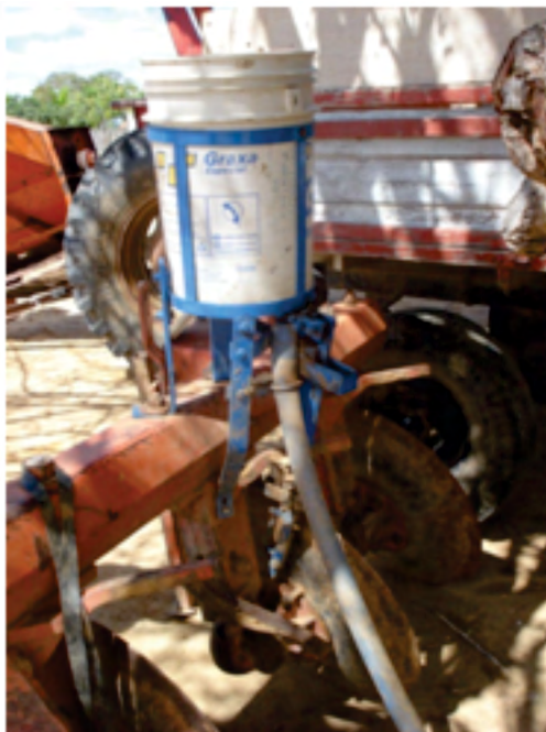
Figura 8 – Conjunto arado e semeadora adaptados para efetuar a aração simultânea à sementeira
