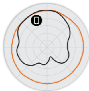
圖 4 C110 2.4GHz 仰角天線模式
