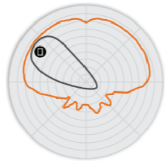
圖 5 C110 5GHz 仰角天線模式
