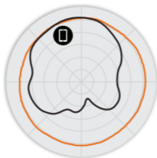
圖 3 C110 5GHz 方位角天線模式
