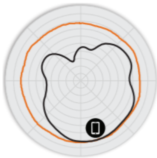
圖 2 C110 2.4GHz 方位角天線模式
