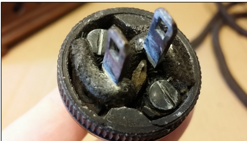
Lanterne: bouchon corrodé.
