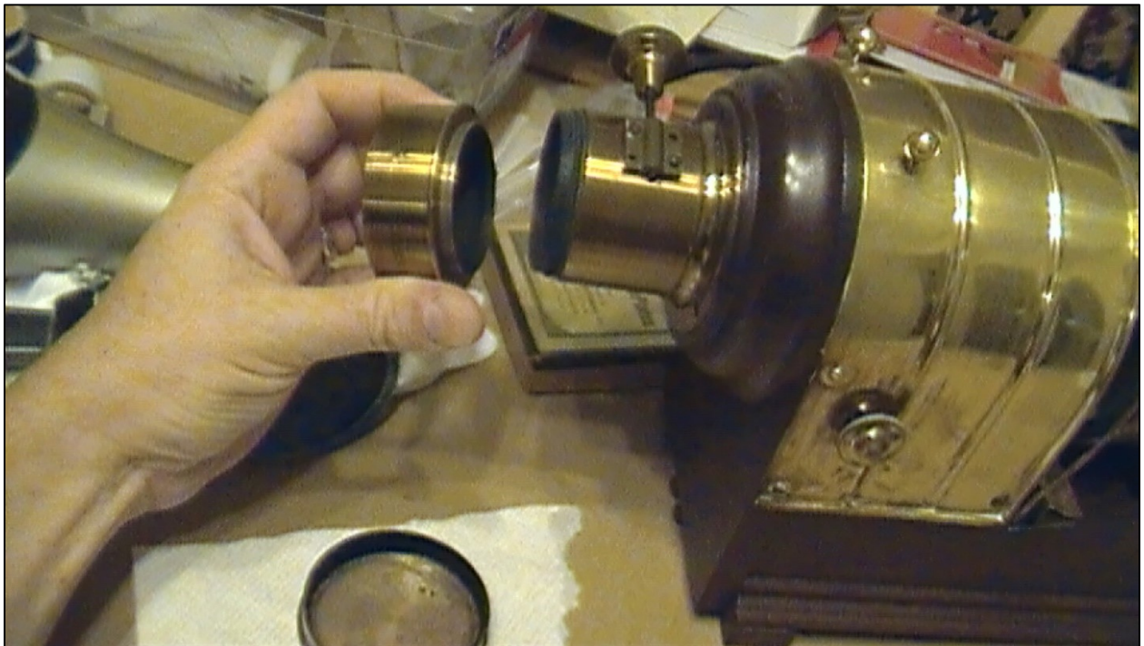
Lanterne : Tous les composants de la lentille ont été séparés et nettoyés.
