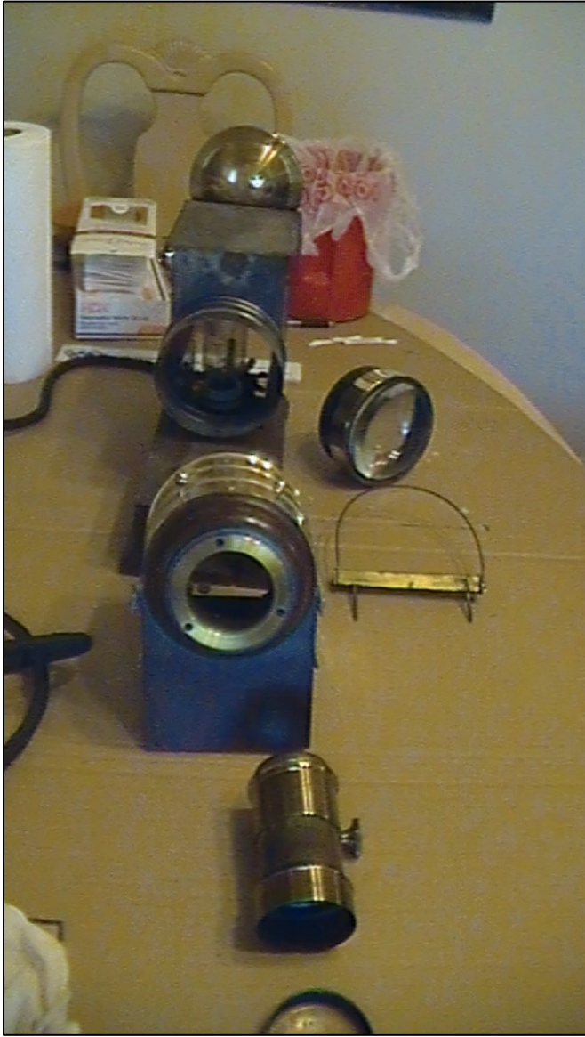
Lanterne : montre quelques-uns des composants retirés pour le nettoyage.
