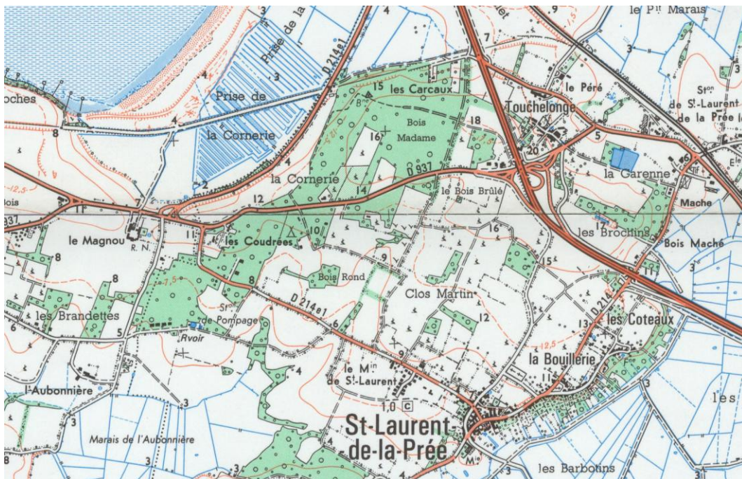
F1953_05/a. Carte topographique au 1:25 000, seconde génération, extrait exemplaire. – Suivant le Type 1972 , le tracé des routes est renforcé en orange. – Extrait de la feuille Rochefort , n° 1430 Ouest, Paris IGN, 1980.
