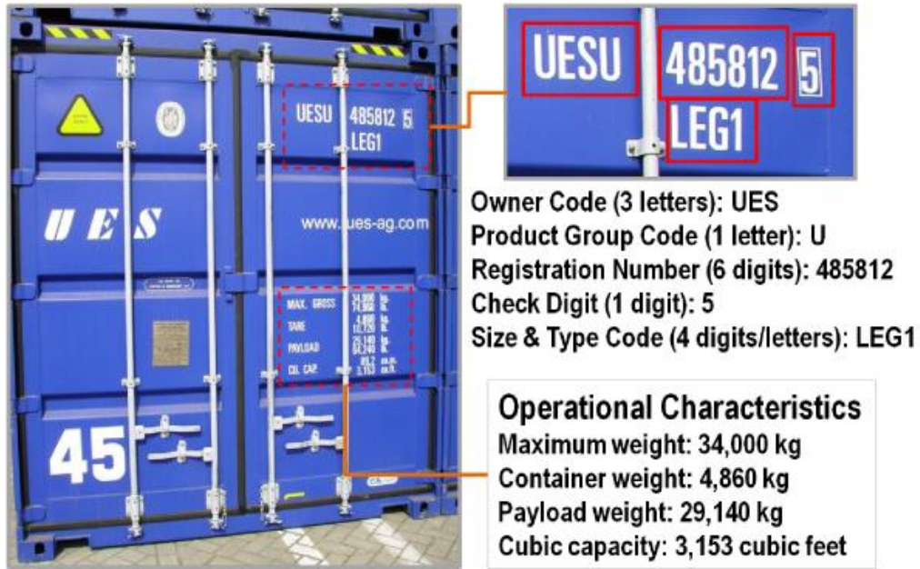
Figura 3.20 - Codi d'identificació, de dimensió i tipus i marques operacionals d'un contenidor Font: adaptació de globalspec.com
