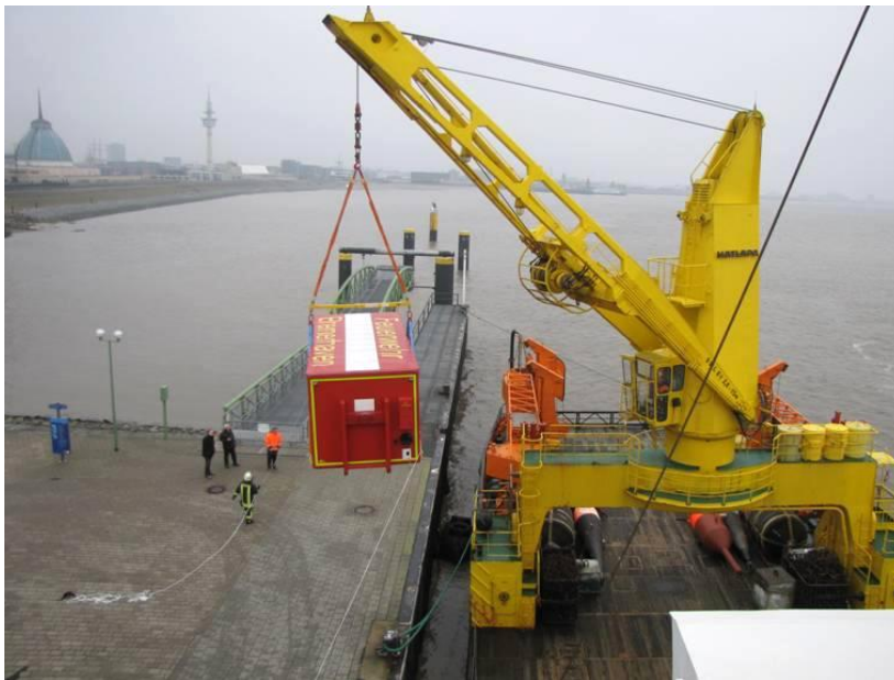
Figura 4.2 - Contenedor roll-off per la lluita contra incendis a bord Font: CHS-Spezialcontainer.com
