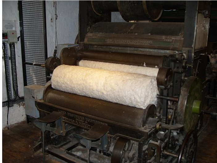
Figure 107 : Machine à carder conservée dans la Quarry Bank Mill (Eyam, Cheshire) 454
