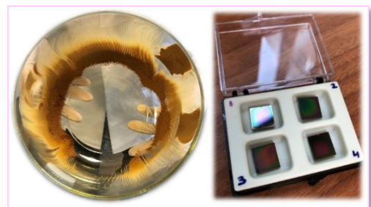
Figure F : Les tholins de Pluton synthétisés à l’aide du dispositif expérimental PAMPRE, sous forme de poudre (à gauche) ou de film mince (à droite).
