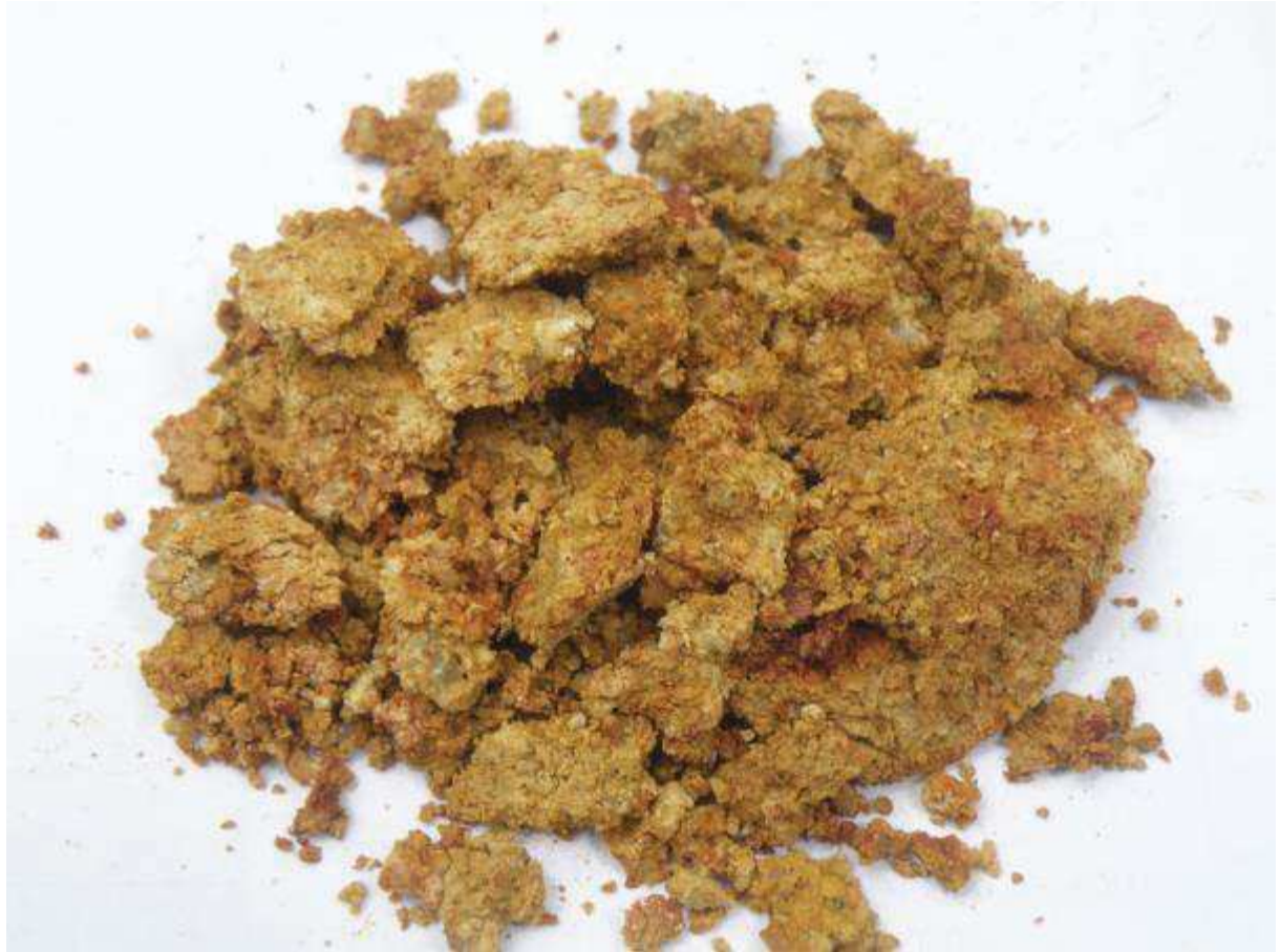
Photo 4-8 : horizon 5 riche en quartz et tâches rouilles
