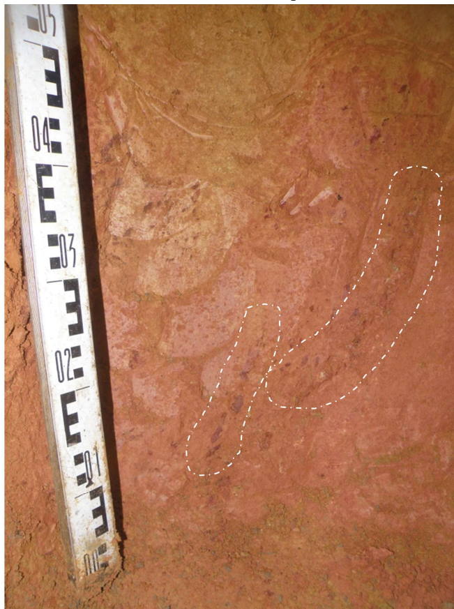
Photo 2-9 : on observe (entourés de tirets blancs) des filons de quartz (à droite) et des restes de cuirasse (à gauche) dans l'horizon 5
