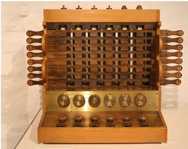
Figure 5. Horloge calculante de Schickard et la Pascaline. Deux des premières machines à calculer de l'histoire, à gauche : réplique du "Rechenuhr" de l'astronome allemand Schickard ; à droite, Pascaline exposée au Musée des Arts et des Métiers à Paris.
