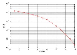
Fig. 18. BER plot versus EbtoNo(dB)
