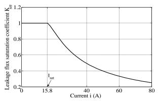
Fig. 4. Leakage flux saturation Coefficient  $K_{s\sigma}$
