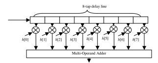
Fig. 1. Basic FIR Filter
