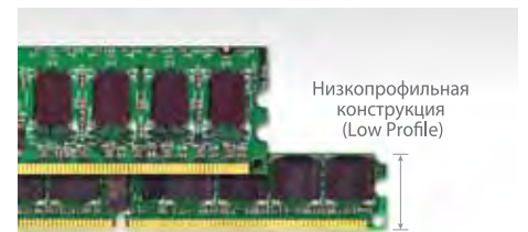
Высота печатной платы при одинаковой плотности (низкопрофильные модели печатных плат)
