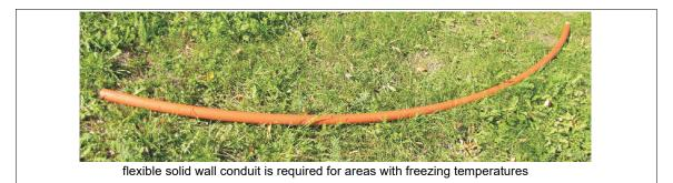
Figure 40 Solid wall conduit
