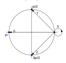
Fig. 56 Logical mapping – pi/4 DQPSK (TFTS)
