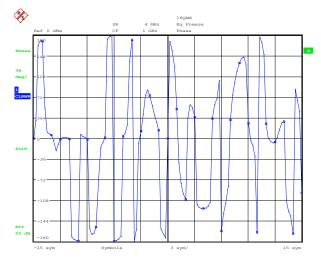
Fig. 209 Result display PHASE(WRAP)
