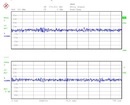
Fig. 183 REAL / IMAG result display
