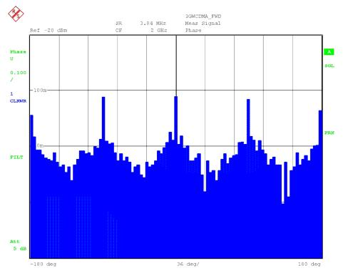
Fig. 178 Result display SIGNAL STATISTIC PHASE
