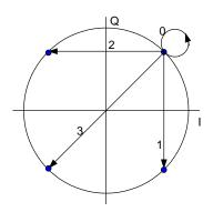
Fig. 51 Physical constellation diagram – DQPSK / INMARSAT
