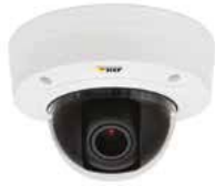
0613-001 AXIS IP Buiten Dome camera P3214-VE, Dag/nacht met IR LED, Lens 2,8-10mm, WDR, 720P Vandaalbestendig
