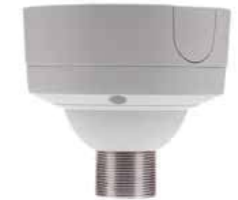
5504-511 AXIS Beugel IP Buiten camera • De plafondbevestiging voor binnenopstelling is ideaal voor ruimtes met lage plafonds, zoals parkeergarages, voorzien van een wartel om breken te voorkomen wanneer er tegen gestoten wordt • Kan gemonteerd worden in schuine plafonds om hoeken tot 45 graden te compenseren • Beschikbaar : optionele verlengbuizen (niet inbegrepen) van 30 cm (12") of 1 meter (39") om de camerahoogte aan te passen voor de specifieke omgeving • Compatibel met alle Axis hangende kits met 1,5" NPS-draad en de AXIS T91A05 • camerahouder voor vaste camera's
