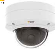
0760-001 AXIS IP Dome Buiten camera P3225-LVE, Dag/nacht met IR LED, Lens 3-10,5mm, WDR, 1080p, Vandaalbestendig
