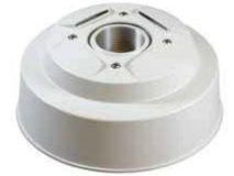
5502-321 AXIS Beugel voor IP Dome Pendelmontage kit Tbv P33-VE serie • Hiermee kan de dome gemonteerd worden via 1,5inch NPT draad of TA91A Beugel
